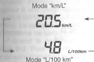
Régler le compteur sur consommation instantanée de carburant ou sur consommation moyenne de carburant puis appuyer et laisser le doigt sur la commande de MODE (moitié inférieure) pendant 2 secondes pour passer du mode "km/L" au mode "L/100km".
