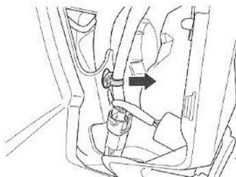
2. Déposer les boulons et les fixations.
