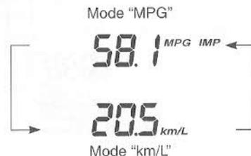
Pour passer du mode "MPG" au mode "km/L" (L/100 km), régler le compteur sur compteur kilométrique puis appuyer et laisser le doigt sur le bouton ADJUST ① pendant 2 secondes.
