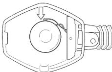
2. Appuyer sur l'ampoule, tourner vers la gauche et l'extraire.
