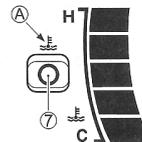
L'indicateur de température de liquide de refroidissement indique la température du liquide de refroidissement. Quand la température du liquide de refroidissement est trop élevée, la marque ⑫ et le témoin ⑦ s'allument.
