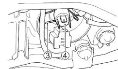
2. Décrocher le ressort de retenue de l'ampoule ③ et extraire l'ampoule ④.
