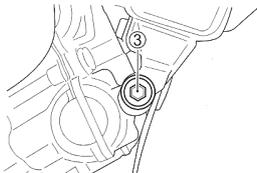
4. Déposer le boulon de fixation du radiateur ③ et repousser le radiateur en avant.
