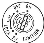
Mettre la clé de contact en position "LOCK" et faire tourner le couvercle du trou avant de laisser la motocyclette.
