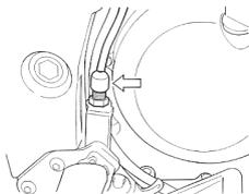
Pour régler le contacteur du feu-stop arrière, le remonter ou le descendre de sorte que le feu-stop s'allume juste avant que la résistance offerte par la pédale se fasse sentir au pied.
