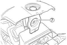
8. Supporter le réservoir de carburant avec le bras d'appui 7.
