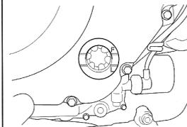
3. Tenir la moto droite et inspecter le niveau d'huile-moteur par le regard d'inspection de niveau d'huile sur le côté droit du moteur.
