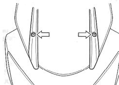
1. Déposer les vis et les plaques.
