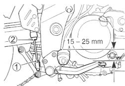
1. Desserrer le contre-écrou ①, et tourner la tige de poussoir ② pour mettre la pédale 15 – 25 mm sous la face supérieure du repose-pied.
