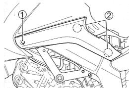
Déposer le boulon ① et les crochets ②. Déposer le couvercle.
