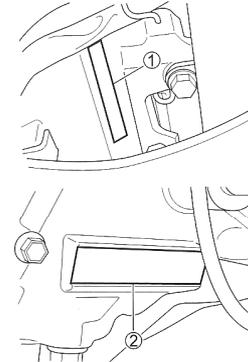
Les numéros de série du cadre et/ou du moteur servent à l'immatriculation de la moto. Ils sont également utiles au concessionnaire pour la commande de pièces ou pour repérer des informations d'entretien spéciales. Le numéro du cadre ① est estampé sur le tube de la colonne de direction. Le numéro de série du moteur ② est estampé sur le carter-moteur.
