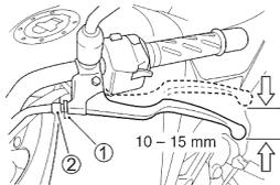
A chaque intervalle d'entretien, régler le jeu du câble d'embrayage à l'aide de la molette de réglage de ce câble. Le jeu du câble doit être de 10 – 15 mm au niveau du levier d'embrayage avant que celui-ci ne commence à se désengager. Si le jeu de la poignée d'embrayage n'est pas correct, le régler de la manière suivante:
