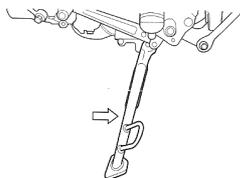
Un contacteur de sécurité coupe le circuit d'allumage quand la béquille est déployée et quand la boîte de vitesses est dans un rapport quelconque autre que le point mort.
