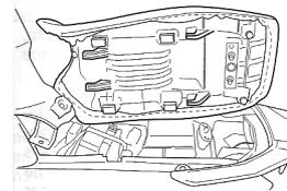
Pour reposer la selle, glisser les crochets de selle dans les arrières et appuyer fermement pour bloquer la selle en position.
