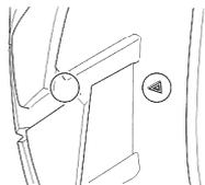
**NOTE:** La marque "Δ" indique l'endroit où les témoins d'usure sont moulés dans le pneu. Quand les témoins d'usure sont en contact avec la route, ceci indique que la limite d'usure du pneu est atteinte.
