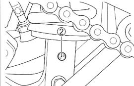
Le dispositif de réglage de la force d'amortissement à course de rebond ② se trouve en bas de l'amortisseur de la suspension arrière. Pour régler la force d'amortissement, régler le dispositif de réglage sur la position standard et régler ensuite sur la position désirée. Pour régler la vis de réglage de force d'amortissement de compression sur la position standard;
