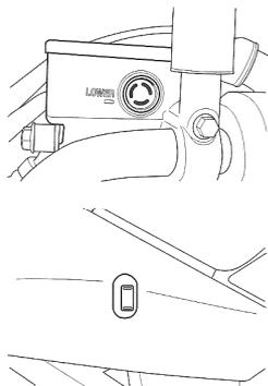
Vérifier le niveau du liquide de frein dans les réservoirs des freins avant et arrière. Inspecter les plaquettes de frein pour usure et fuites.
