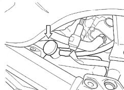
Déposer le bouchon du goulot de remplissage et ajouter la quantité nécessaire de liquide de refroidissement jusqu'au trait de repère "F". Se référer à la section RECOMMANDATIONS SUR LE CARBURANT, L'HUILE-MOTEUR ET LE LIQUIDE DE REFROIDISSEMENT.
