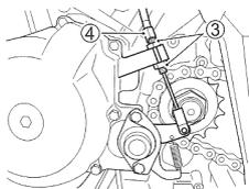
4. Desserrer les contre-écrous de la molette de réglage du câble ③ et faire tourner la molette de réglage du câble ④ pour obtenir approximativement un jeu de 10 – 15 mm à l'extrémité du levier d'embrayage comme indiqué.
