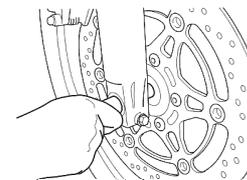
7. Tourner l'arbre de roue dans le sens contraire des aiguilles d'une montre et l'extraire.
