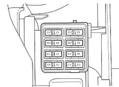
Les fusibles sont situés sous la selle. Un fusible de rechange de 10A et un fusible de rechange se 15A se trouvent dans la boîte à fusibles.
