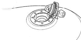
Pour ouvrir le bouchon du réservoir de carburant, insérer la clé de contact dans la serrure et tourner dans le sens horloger. Avec la clé insérée, lever avec la clé et ouvrir le bouchon du réservoir de carburant. Pour refermer le bouchon du réservoir de carburant, appuyer fermement sur le bouchon sans retirer la clé.
