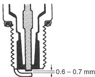
Nettoyer les dépôts de calamine des bougies en procédant à l'aide d'un fil métallique ou d'une épingle. Régler l'écartement de la bougie à 0,6 – 0,7 mm avec un calibre d'épaisseur pour bougie. Changer les bougies tous les 12000 km.
