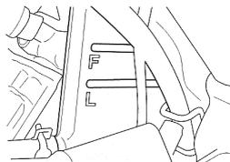
Le niveau du liquide de refroidissement doit toujours être entre les traits "F" (MAXI) and "L" (MINI) sur le réservoir. Inspecter le niveau avant de conduire, la moto droite. Si le niveau du liquide de refroidissement est inférieur au trait de repère "L", faire l'appoint en liquide en procédant de la manière suivante:
