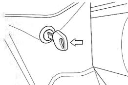
Pour déposer la selle, insérer la clé de contact dans la serrure et tourner dans le sens horloger. Relever l'arrière de la selle et repousser en arrière.
