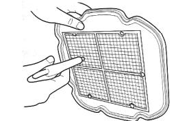
8. Nettoyer avec soin à l'air comprimé pour enlever la poussière de l'élément du filtre à air.
