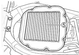
7. Déposer l'élément du filtre à air ⑤.
