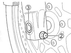
3. Desserrer le boulon du support d'axe ② sur la fourche avant droite.
