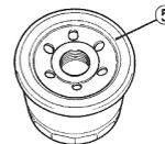
8. Enduire légèrement d'huile-moteur le pourtour du joint en caoutchouc ⑤ du filtre à huile neuf.
