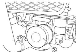
6. Visser le filtre à huile ③ dans le sens contraire des aiguilles d'une montre avec une clé à filtre à huile Suzuki de taille appropriée.
