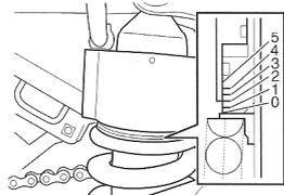
Pour régler la précharge du ressort de suspension arrière, tourner la molette de réglage ①. En tournant la molette de réglage dans le sens horloger, la précharge du ressort est augmentée et en tournant dans le sens contraire, la précharge du ressort est réduite. La position 0 donne la précharge de ressort la plus molle et la position 5 la plus dure. Cette moto est réglée en usine avec la molette de réglage sur la position 2.
