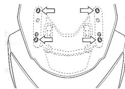
2. Déposer les vis et le pare-brise.
