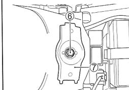
6. Déposer le boulon ⑥. Déposer le bras d'appui ⑦.
