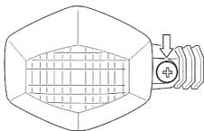
1. Déposer la vis et enlever le diffuseur.
