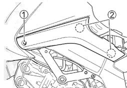
3. Déposer le boulon ① et les crochets ②. Déposer les caches.
