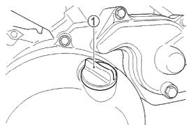
2. Déposer le bouchon de remplissage d'huile ①.
