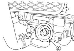
7. Essuyer la surface de contact ④ sur le moteur où le filtre à huile neuf est installé avec un chiffon propre.
