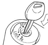
Avant d'insérer la clé de contact, aligner le trou du couvercle avec celui de la clé.
