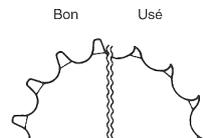
*NOTE: Les deux pignons devront être inspectés pour usure quand une chaîne neuve est reposée et les remplacer si nécessaire.*
