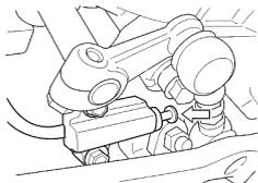
Vérifier le bon fonctionnement du contacteur de sécurité de béquille latérale/allumage de la manière suivante:
