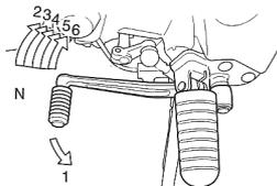
Cette moto est pourvue d'une transmission à 6 vitesses qui fonctionne comme illustré. Pour un bon passage des vitesses, serrer le levier d'embrayage et fermer le papillon des gaz tout en manoeuvrant le levier du sélecteur. Lever le levier du sélecteur pour monter les vitesses et l'abaisser pour les descendre. Le point mort se trouve entre la 1ère et la 2ème. Pour passer au point mort, appuyer sur ou relever le sélecteur à mi-course entre la 1ère et la 2ème.
