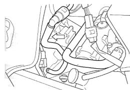
Vérifier le bon état et l'absence de fuite du flexible à carburant. En cas de détérioration quelconque, changer le flexible à carburant.
