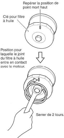
10. Marque la position du point mort haut sur la clé à filtre ou sur le filtre à huile. Utiliser une clé à filtre pour resserrer le filtre de 2 tours.
