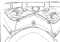
4. Déposer les attaches ③ et les boulons ④.
