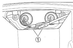
1. Tourner la douille ① dans le sens contraire des aiguilles d'une montre et la déposer.
