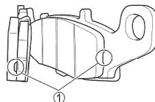
Inspecter les plaquettes de frein avant et arrière en vérifiant si les plaquettes de frictions sont usées au-delà du trait limite d'usure ①. Si une plaquette est usée au-delà du trait limite d'usure, faire remplacer la plaquette par une neuve par le concessionnaire Suzuki ou un mécanicien qualifié.
