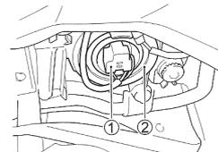
1. Déconnecter la douille ① du phare et déposer le capuchon en caoutchouc ②.
