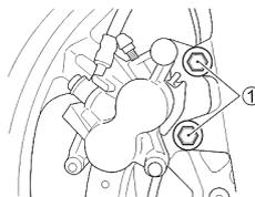
2. Déposer les deux étriers de frein de la fourche avant en déposant les deux boulons de fixation ① sur chaque étrier.
