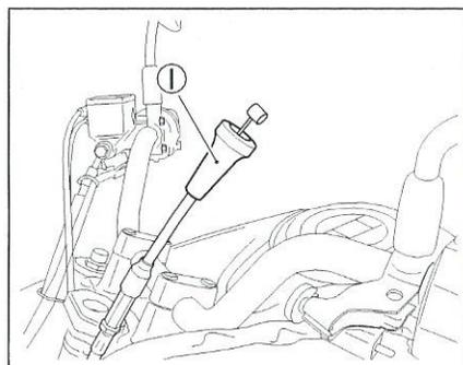
6. Reposer le câble d'embrayage et en régler le jeu.
