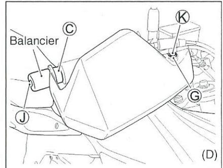
7. Reposer la rondelle (G) et serrer l'écrou (L). (G et D)
